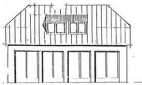
Krüppelwalmdach mit ausgebautem Dachgeschoss im Vollgeschossmaßstab
