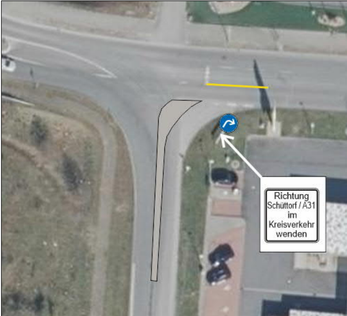
Abbildung 31: Bauliche Maßnahmen zur Durchsetzung der Regelung "rechts-raus"
